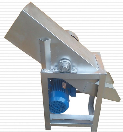
سیستم یخ خرد کن مخصوص دستگاه بچینگ پلانت ساخته شده از جنس استنلس استیل خرد کردن قالب یخ در ۱۰ ثانیه
