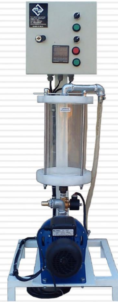
دستگاه تزریق مواد افزودنی بتن قابلیت بارگیری انواع مواد افزودنی بتن مانند: ضد یخ ابر روان کننده، فوق روان کننده و سایر مواد افزودنی بتن را دارا می باشد
